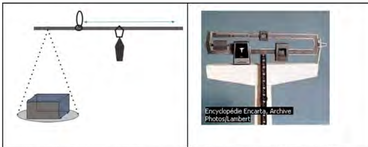
à gauche : Schéma de la balance romaine.. On l'utilisait encore en 1942 pendant la guerre.
